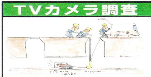
管内を走る自走車にカメラヘッドを搭載し、管内状況を収録しながら、管きょに沿って調査します。これらの調査結果は今後、下水道の維持管理の資料となります。
